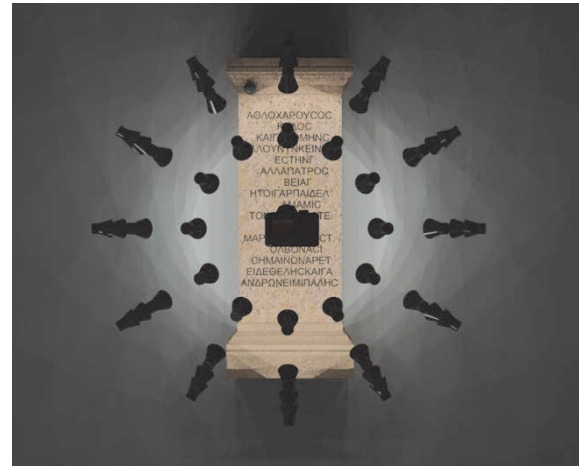
Fig. 14. Materyalin tam küre şeklinde gerçekleştirilen çekim aşaması.
